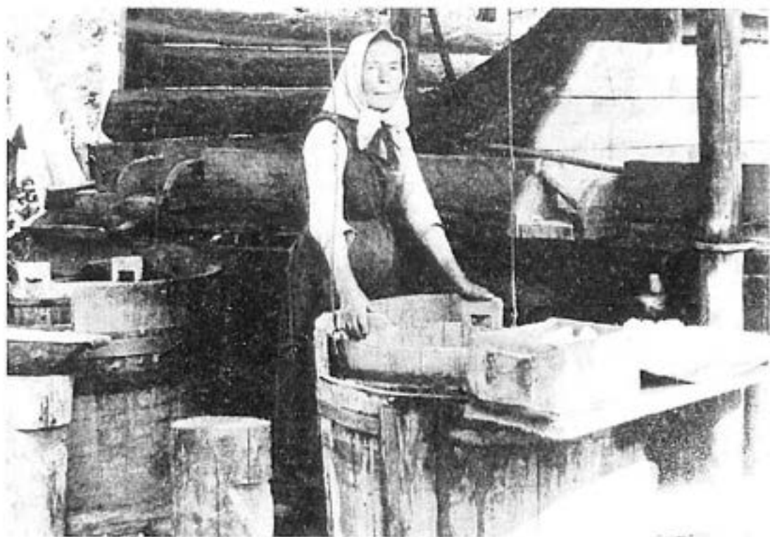
Sieb mit Bottich, das Sieb hängt an einer federnden Holzstange, Zucken genannt
